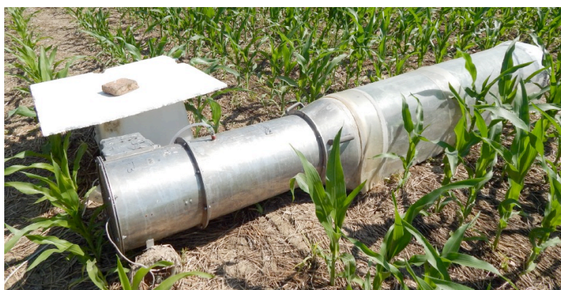
Figura 7.28.2 - Dispositivo di misura delle emissioni di ammoniaca a seguito della distribuzione dei fertilizzanti "tunnel a vento"
